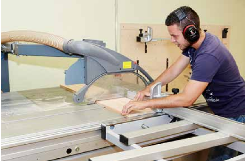
Einsatz im Arbeitstraining/Time-out: an der grossen Tischkreissäge
