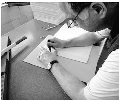
Der Buchdeckel wird für die Verschraubung gelocht.
