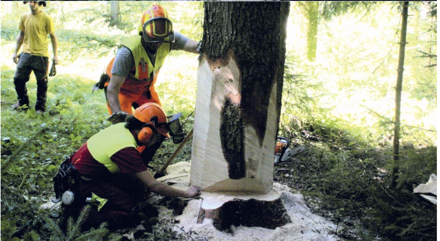
Baumfällen: Einsatz der Motorsäge, messen und bestimmen, damit der Baum in die gewünschte Richtung fällt (Fotos: Remo Antonini).
